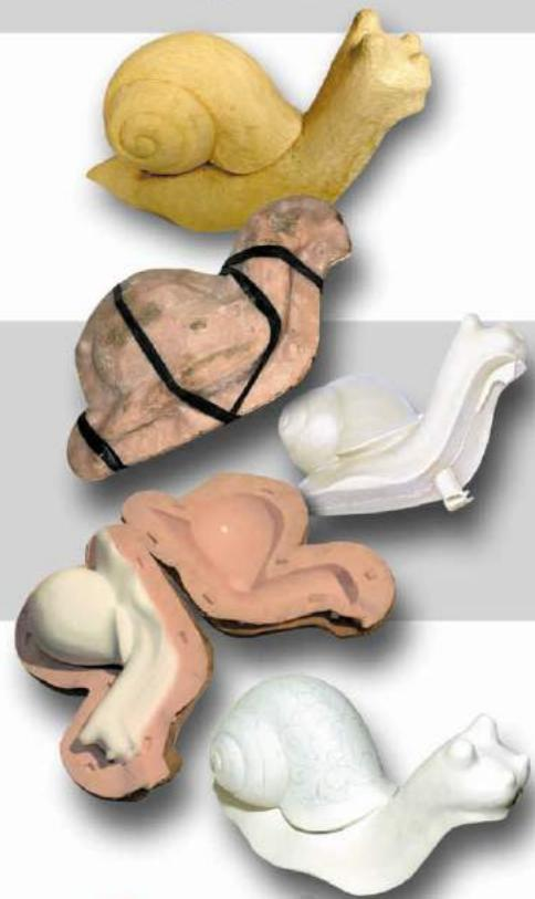
Von Hand wird ein Prototyp aus Holz geschnitzt.
